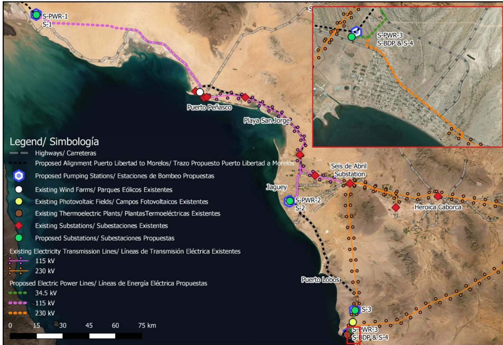
Figure/Figura 54 Opportunity 5 – Proposed electrical power design Oportunidad 5 – Diseño de energía eléctrica propuesto
