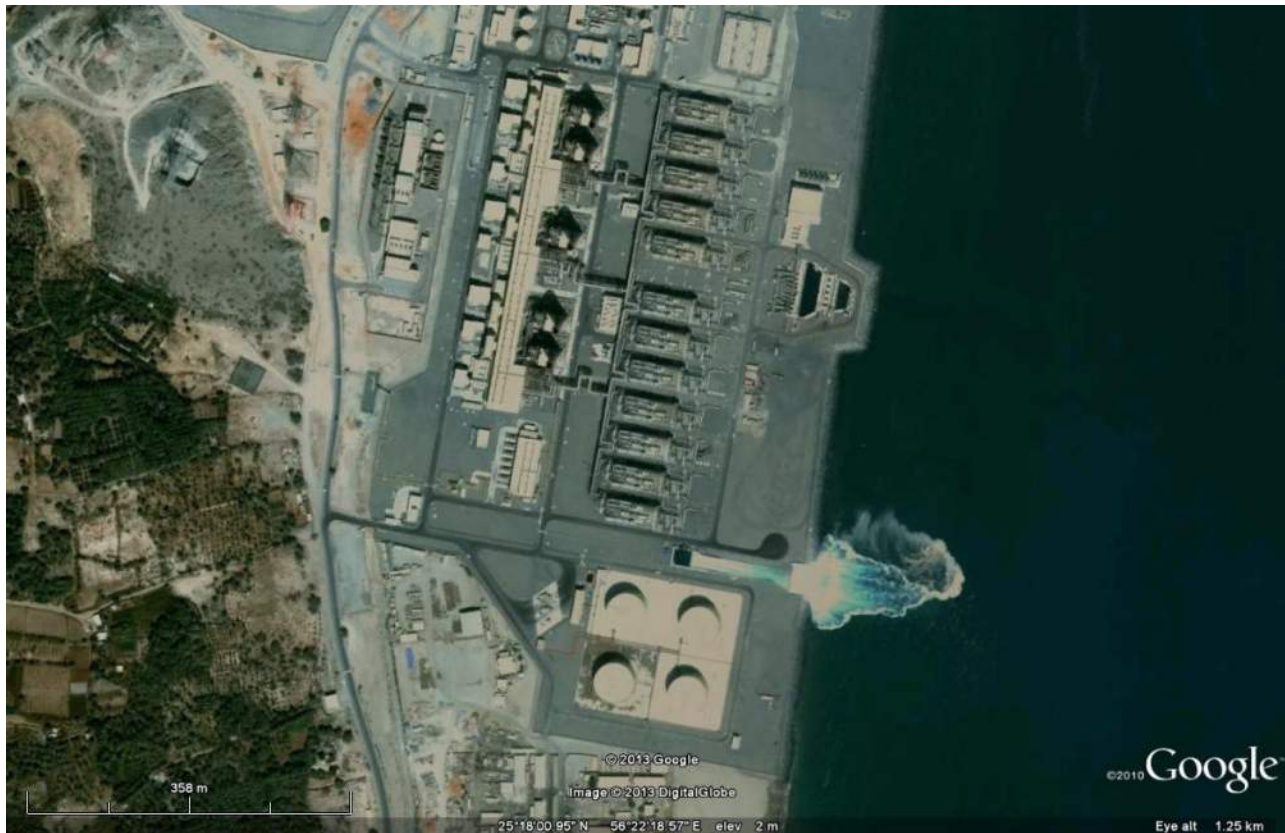
Figure/Figura 10 Concentrate discharge at Fujairah Seawater Desalination Facility, UAE Descarga de concentrado en la instalación de desalinización de agua de mar de Fujairah, EAU
