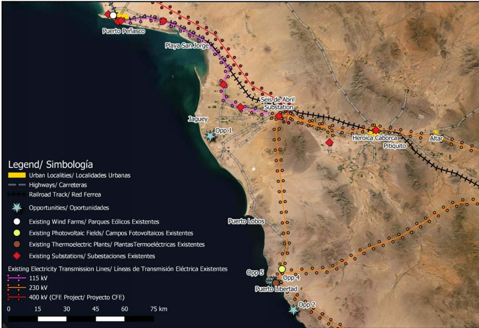
Figure/Figura 18 Existing electrical infrastructure in the study area Infraestructura eléctrica existente en el área de estudio
